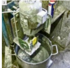
1: Gar nicht so einfach: Redaktor Mark Pollmeier beim Eintauchen der Drahtstäbe für Wunderkerzen. 2: Ebenfalls viel Handarbeit: Mitarbeiterin Suwach Fährndrich verpackt Sturmhölzer. 3: In urchinlichen Rührer bekommt die brennbare Mischung die richtige Konsistenz. 4: Geschäftsinhaber Thomas Willen gehört zur Stammebelegschaft des Familienbetriebs.
